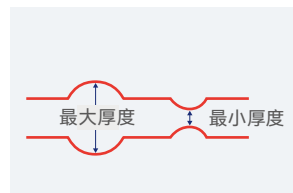
厚度测量: PCB电路板
